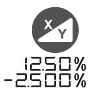
1-ter Tastendruck: Neigungsbetrieb wird aktiviert. Gespeicherte Neigungswerte der letzten Anwendung werden angezeigt und automatisch angefahren.
