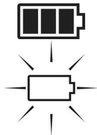
L'affichage de capacité de l'accu indique l'état de l'accumulateur sur 4 niveaux.
