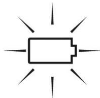
Wenn die 3 Balken in der Anzeige leer sind und der äußere Rahmen blinkt, ist die Kapazität erschöpft und der Akku muss geladen werden. Wird dies nicht beachtet, schaltet das Gerät nach einiger Zeit automatisch ab.
