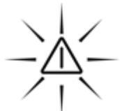
En cas de modifications plus importantes de la position de montage (par ex. après le déplacement involontaire du trépied), une fonction TILT permet de garantir que l'appareil s'éteint et indique le déplacement par un clignotement rapide du rayon laser et du triangle d'avertissement.
