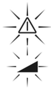
En cas de modification de la position de l'appareil due à des influences extérieures comme des vibrations ou de grands écarts de température, le mode Rotation est interrompu automatiquement. Ceci permet d'éviter les mesures erronées. Le rayon laser, le symbole d'inclinaison et l'affichage d'avertissement clignotent rapidement sur l'écran.
