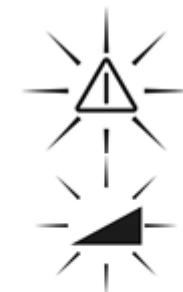
Appuyer à nouveau sur la touche d'inclinaison permet de réactiver le mode d'inclinaison, l'appareil se remet à l'horizontale et l'appareil se déplace à nouveau jusqu'aux valeurs enregistrées pour l'inclinaison.
