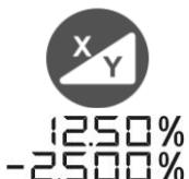
1-ter Tastendruck: Neigungsbetrieb wird aktiviert. Gespeicherte Neigungswerte der letzten Anwendung werden angezeigt und automatisch angefahren.
