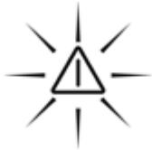
En cas de modifications plus importantes de la position de montage (par ex. après le déplacement involontaire du trépied), une fonction TILT permet de garantir que l'appareil s'éteint et indique le déplacement par un clignotement rapide du rayon laser et du triangle d'avertissement.
